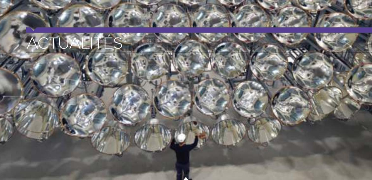
Nommée **Synlight**, cette structure alvéolaire de 14 mètres de haut pour un diamètre de 16 mètres est composée de 149 lampes au xénon.
