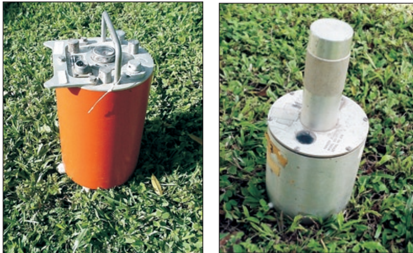
Figs. 27 y 28. A la izquierda un modelo de sismómetro corto período S-13. A la derecha el sismómetro marca Ranger. Ambos instrumentos son utilizados en la captación de la señal sísmica.
