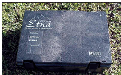
Fig. 37. Acelerógrafo usado en la Red Nacional Acelerográfica.
