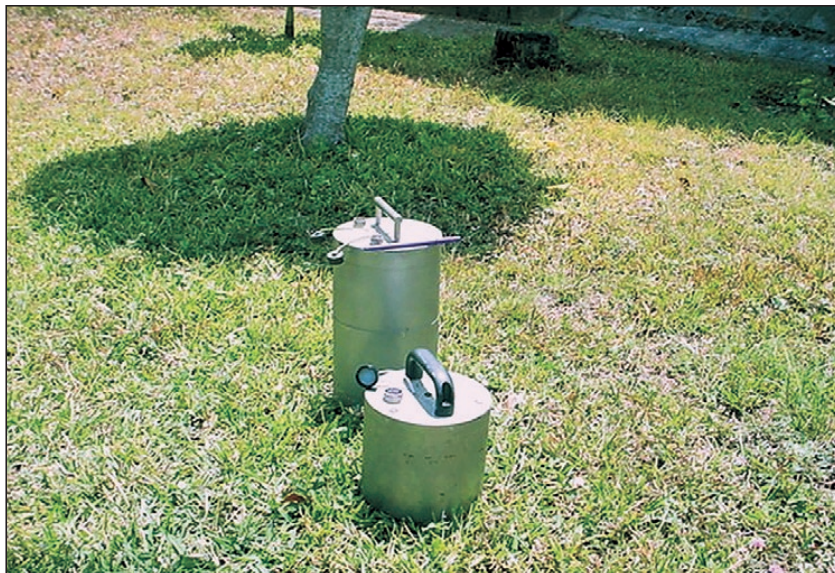
Fig. 29. Se observan dos sismómetros de banda ancha, modelo Guralp. El de la derecha se usa en las modernas estaciones satelitales.
